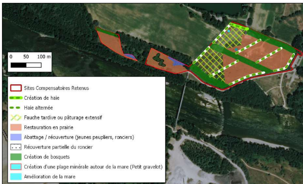
Mesures compensatoires – Site 10 sud
