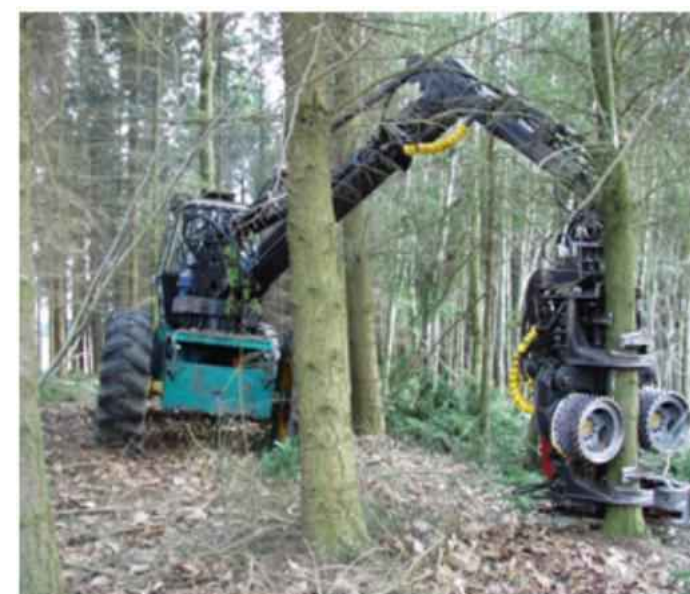
Figure 6: Abattage et façonnage des grumes de bois (Source : SNCF Réseau)
