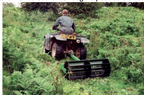
Figure 18 : Brise-fougère tracté par un quad – Tim Hannah
