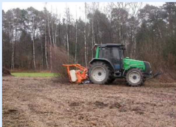
Figure 2 : Opération de broyage – Renaturation de zones humides, CSA
