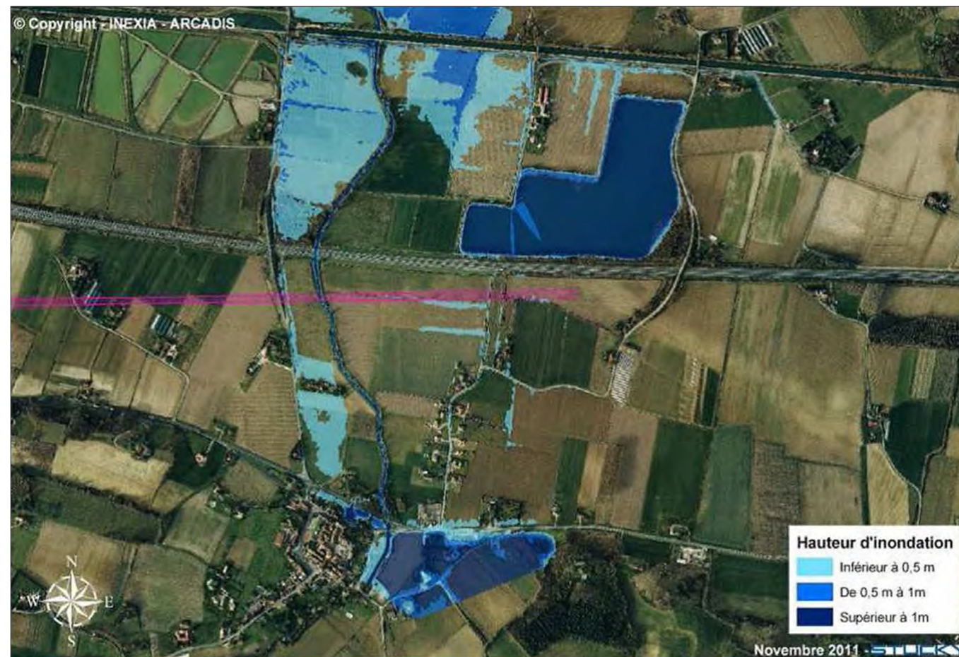
Figure 32: Modélisation de la crue décennale de l'Auvignon au droit de l'aire d'étude (Source : Inexia – Arcadis, 2011)
