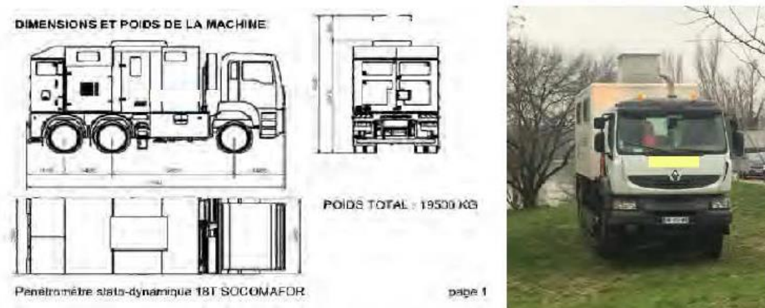
Figure 3 - Exemple de machine d'essai de pénétration statique (Source : SNCF Réseau)
