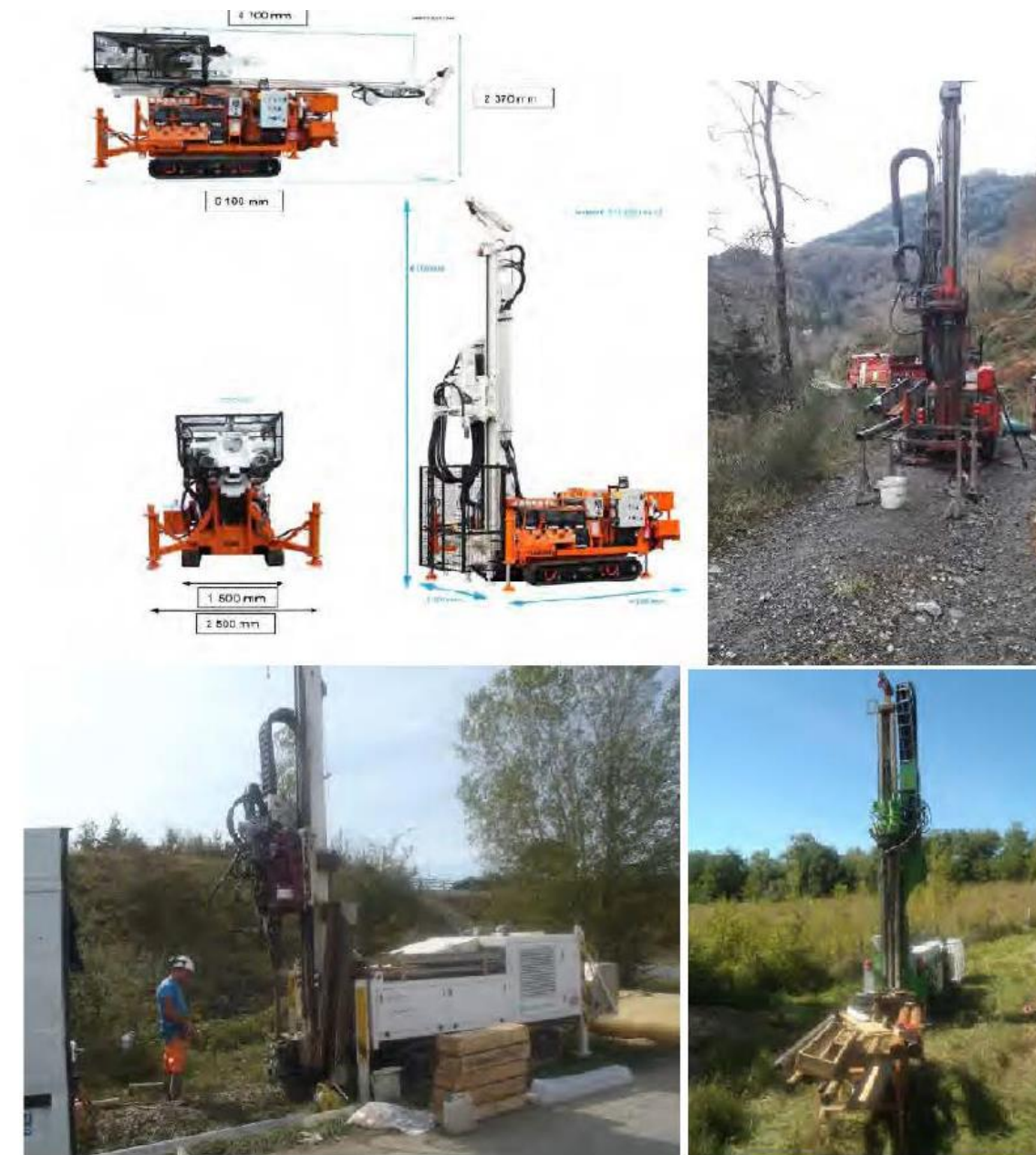
Figure 2 - Exemple de machines utilisées dans le cas de sondage carotte, à la tarière, ou pressiométrique (Source : SNCF Réseau, 2024)
