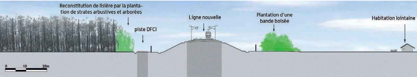
Figure 100: Coupe de principe pour le passage dans un airial : plantation d’une bande boisée pour créer un masque visuel côté riverains. (Source : Egis, 2013)
